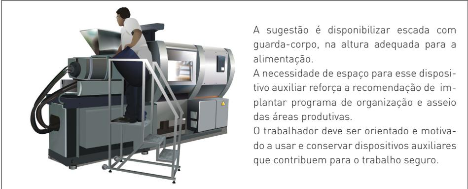
**Figura 16 - Escada com guarda-corpo para alimentação das máquinas.**
