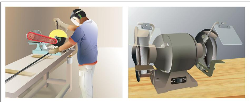
**Figura 17 - Equipamentos policorte e esmeril com proteções.**
